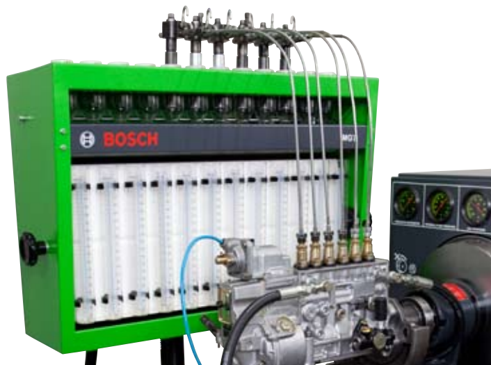
Sistema de medição por proveta graduada
